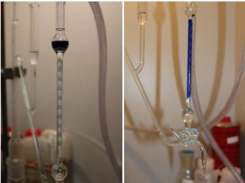
Abb. 6: Messskala der Apparatur zur Wasserdampfdestillation nach Europäischem Arzneibuch mit ätherischem Öl der Kamille (blau) in der Sammelblase oder der Messskala.
