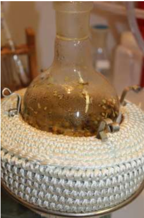
Abb. 7: Heizpilz und Erlenmeyerkolben mit jeweils einer definierten Menge Tee-Droge und Extraktionsmittel Wasser als Teil der Apparatur zur Wasserdampfdestillation nach Europäischem Arzneibuch
