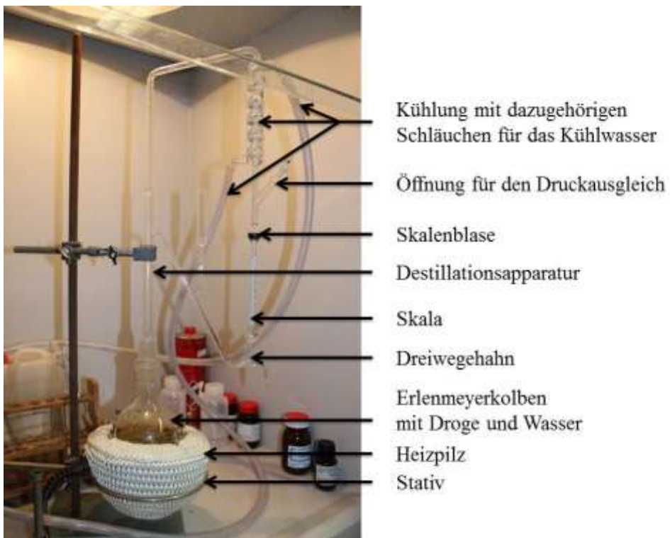
Abb. 5: Apparatur zur Wasserdampfdestillation nach Europäischem Arzneibuch
