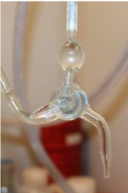
Abb. 8: Dreivegehahn als Teil der Apparatur zur Wasserdampfdestillation nach Europäischem Arzneibuch
