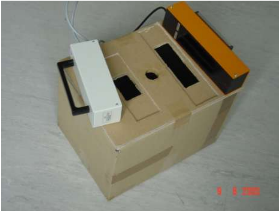
Abbildung 5 Detektionskammer mit Einsätzen für UV-Lampen (links und rechts), Fotoapparat (mitte) und UV-Lampen
